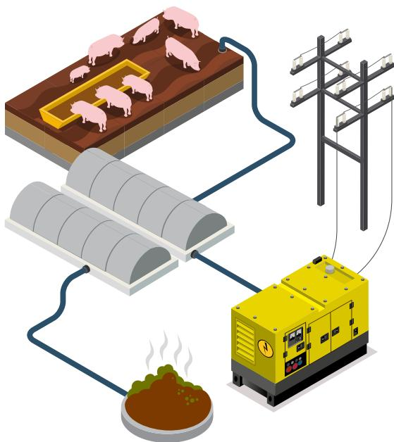
Por meio de um processo fermentativo (biodigestão) que ocorre na ausência de oxigênio (Anaerobiose) os resíduos orgânicos são degradados a compostos mais simples, reduzindo seu poder poluente e gerando o BIOGÁS.
